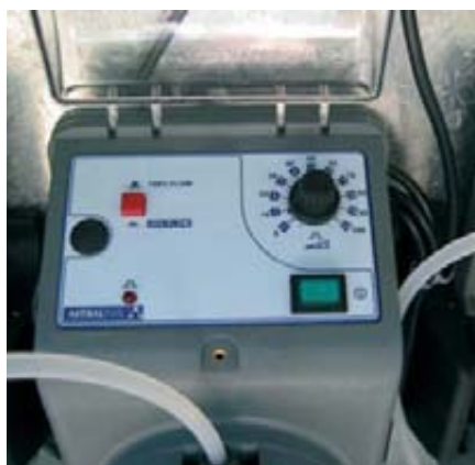
Foto 4. Bomba de inyección que permite fraccionar la cantidad total de abono aplicado mediante fertirrigación.
